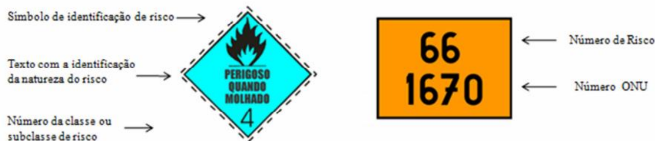
Figura 1 – Rótulo de Risco e Painel de Segurança
